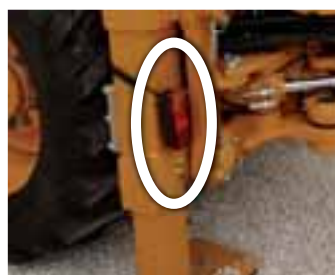
Задние дорожные фары могут устанавливаться на опорах стабилизатора при движении, а также на кабине при выемке грунта, обеспечивая максимальную видимость и защиту
